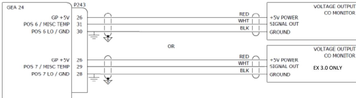
**MAKE SURE THE BLACK GROUND WIRE IS GROUNDED TO AIRCRAFT GROUND AS THE PIN GROUNDS (E.G. PIN 30 AND 28) ON THE GEA 24 MAY NOT ALWAYS BE CONNECTED TO AIRCRAFT GROUND.**
